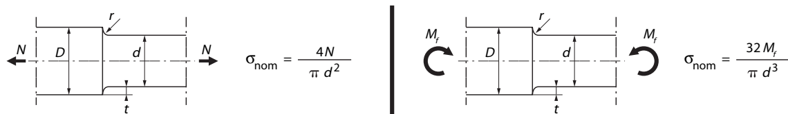
FIG. 6.6: Calcul de la contrainte nominale
