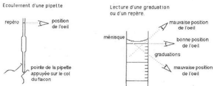
**Pour une mesure précise, veiller à ne pas laisser de bulle dans la burette ou la pipette !**
