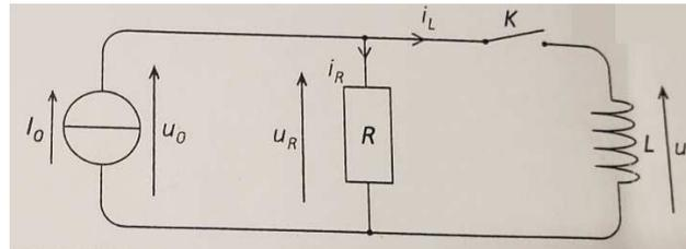
1. Déterminer, à l'aide des lois de Kirchhoff et de la loi d'Ohm, les valeurs initiales des grandeurs  $i_L(0^+)$ ,  $i_R(0^+)$ ,  $u_R(0^+)$ , et  $u_L(0^+)$  en fonction de  $I_0$  et  $R$ .
