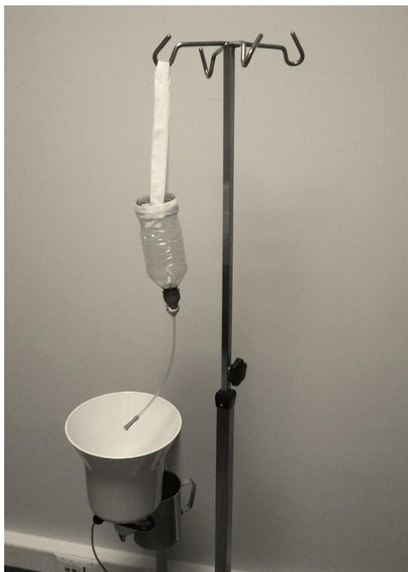
**Figure 1.** Montage expérimental. Bouteille plastique remplie d'un litre d'eau, avec sonde introduite par son extrémité distale. L'ensemble était placé sur une potence réglable afin que le godet de la sonde se retrouve à la partie haute du débitmètre.
