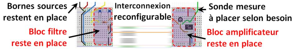
FIGURE 3: Câblage par blocs sur la plaque à trous
