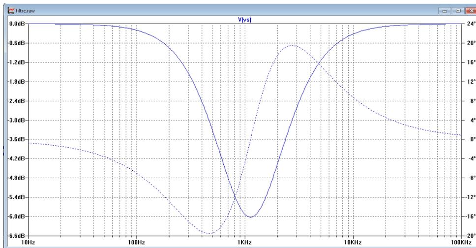
FIGURE 6: Diagramme des gains (en trait plein; échelle de gauche) et diagramme des phases (en pointillés; échelle de droite).
