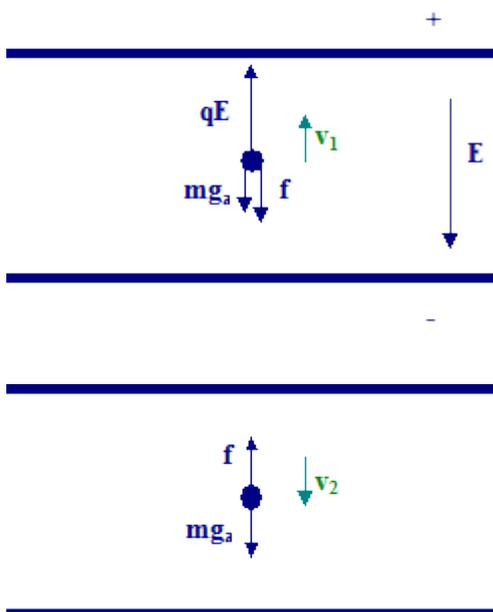
Pendant la montée :  $q E - m g_a = 6 \pi \eta r v_1$
