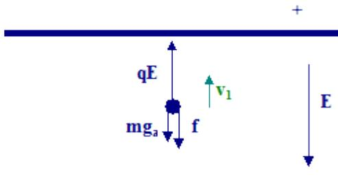
Pendant la montée :  $q E - m g_a = 6 \pi \eta r v_1$
